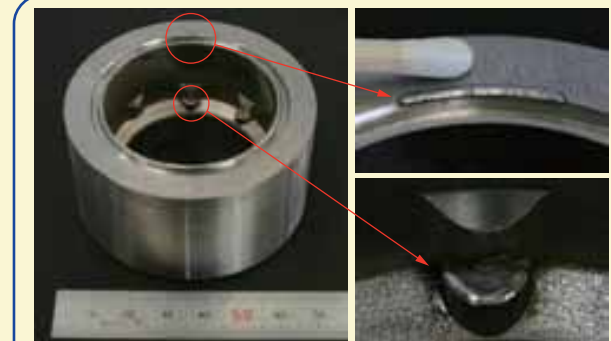
R 部位・深处部位 的修补 ( 材料：NAK-80)
