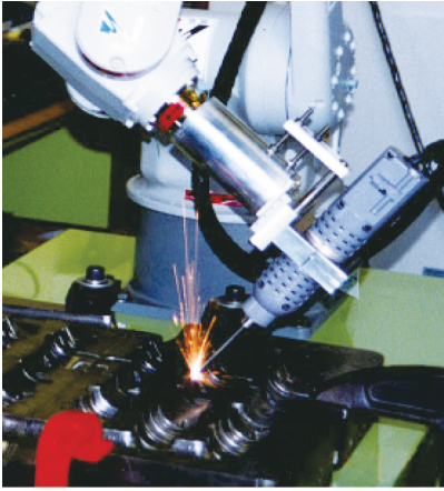
利用涂层机械手来给铝铸造模具涂层
