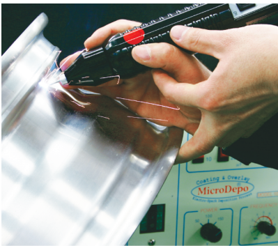
汽车铝圈针孔的堆焊修补
